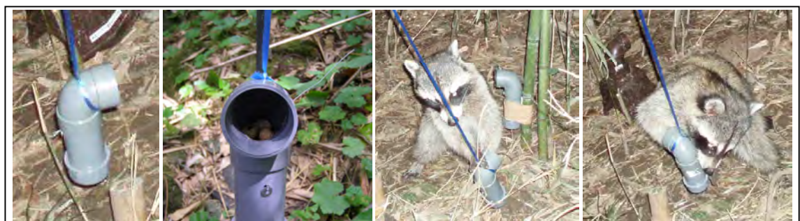
図 3-23 曲塩ビ管を用いたアライグマ専用誘引餌箱（左の 2 枚）とそれに手を入れるアライグマ（右の 2 枚）
