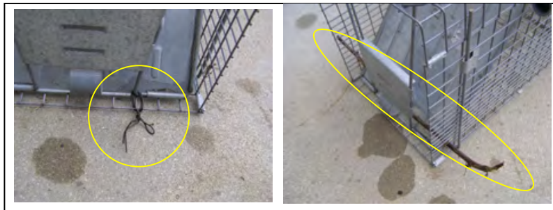
図 3-30 捕獲を確認したら、扉が開かないように針金等で扉をとめる（左）。もし針金がない場合は、適切などころに棒などを差し込む（右）
