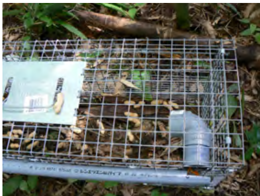
図 3-21 トリガーを曲塩ビ管内引っ張り式に改良
