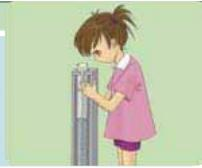
透視度は、水の濁り具合を表し、視覚的に捉えやすい項目です。透視度計（クリンメジャー）を使って調べましょう。透視度計が手に入らない場合は、アクリルパイプなどを加工して自作し、使用しても良いでしょう。透視度計のパイプに川の水を入れ、直射日光を避け、十字二重線のついた標識板をパイプ中で上下させ、十字二重線がはっきり見えた時の水深がその水の透視度になります。
