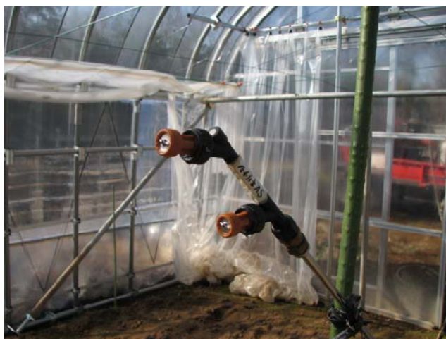
図 I -4. 飛散低減ノズル (ヤマホ・キリナシSVノズル2頭口)
