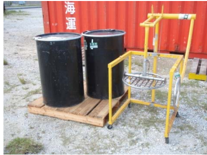
図 3.4-3 溶剤入りドラム缶と手動式ドラム缶用減容機
