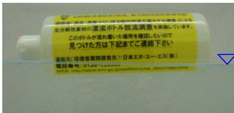
図 2 漂流ボトルの沈下状況（塩分濃度 32.5 の海水を使用）
