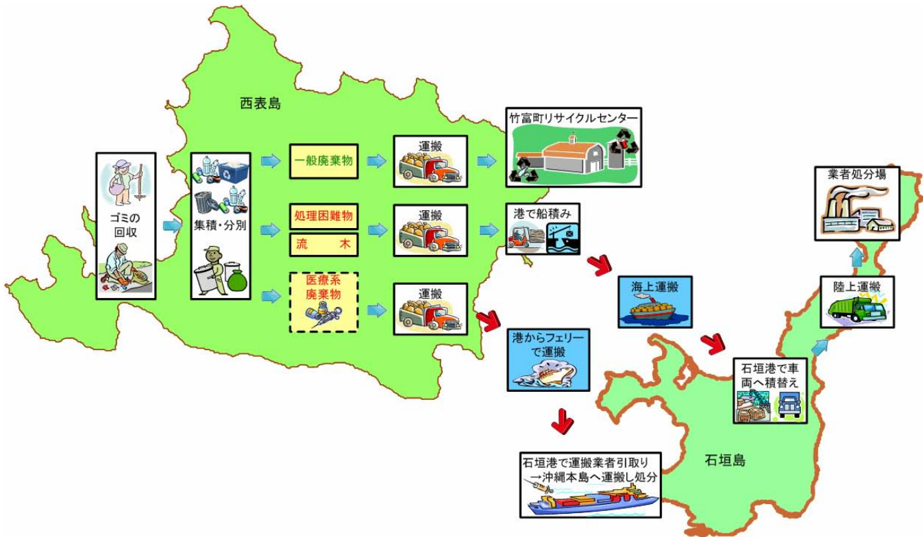
図 2.2-8 西表島地域における漂着ゴミの回収・運搬・処分方法の流れ
