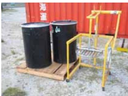
図 3.2-18 溶剤入りドラム缶と手動式ドラム缶用減容機
