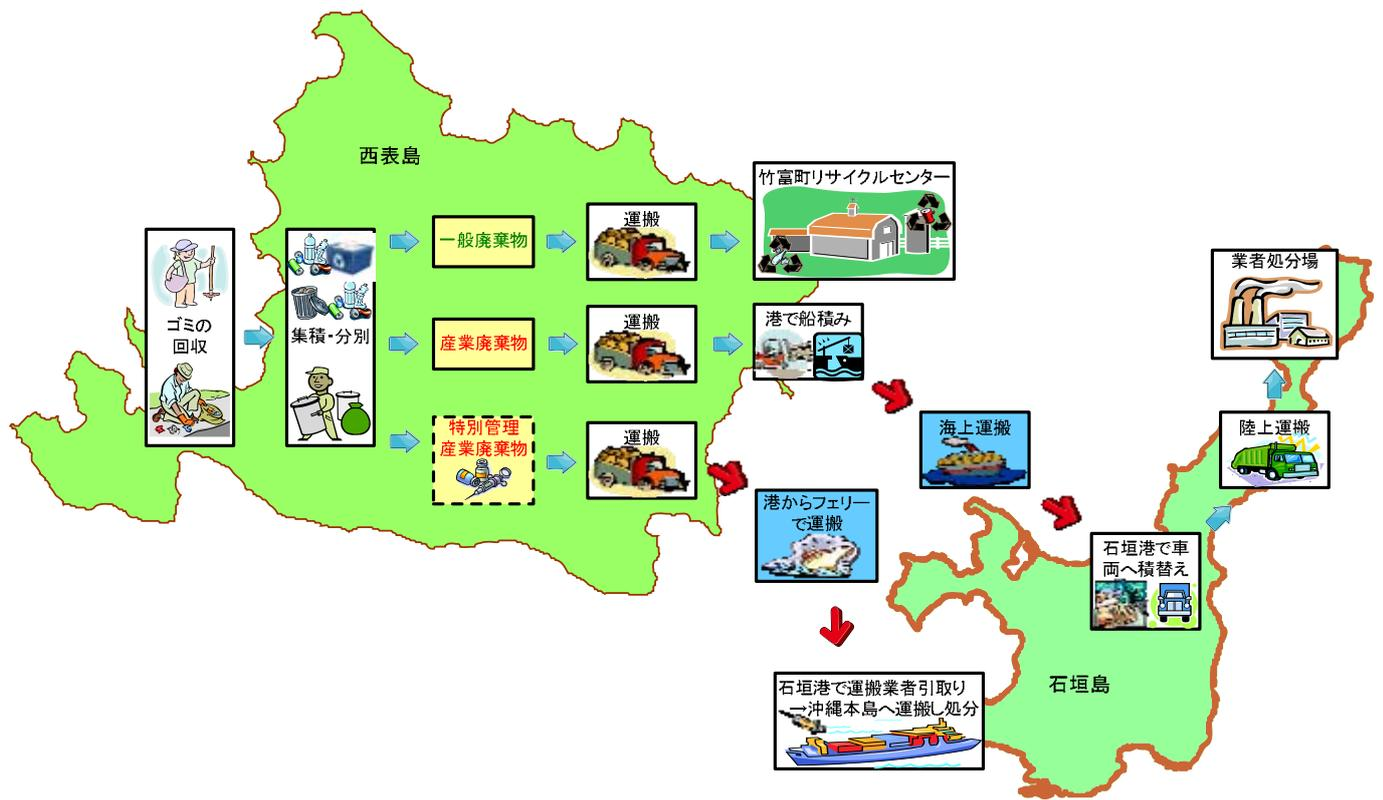
図 3.2-2 西表島における回収・運搬・処分の流れ
