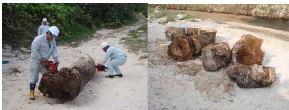
図 2.4-3 チェーンソーによる流木の切断作業（左）と切断した流木（右）
