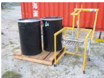
図 3.2-16 溶剤入りドラム缶と手動式ドラム缶用減容機
