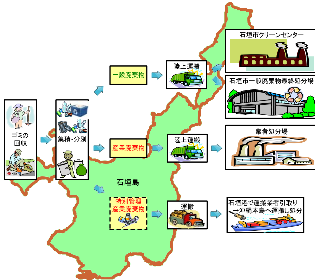
図 22 石垣島独自調査における漂着ゴミ回収運搬処理の模式図
