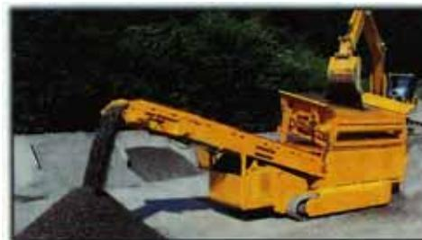
砂混じりゴミの山をバックホウでスクリーンに入れて分別する。砂の山とヨシの山となる。
