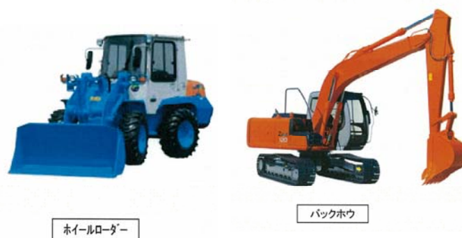
図 39 使用を検討する重機（熊本県上天草市龍ヶ岳町 樋島海岸）
