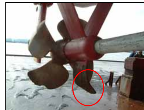
破損(変形)したスクロー
