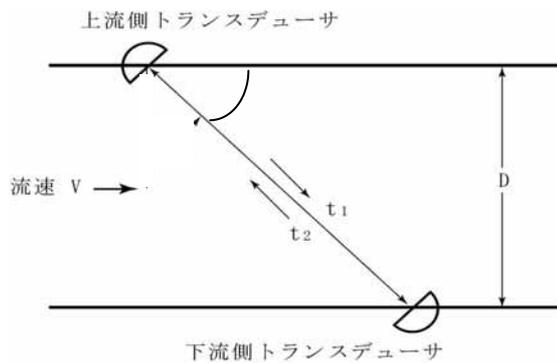
図 6-9 伝搬速度差法の原理
