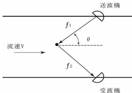
図 6-10 ドップラー法の原理
