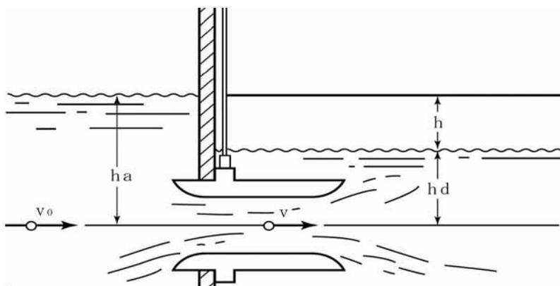
図 6-5 潜水電磁式
