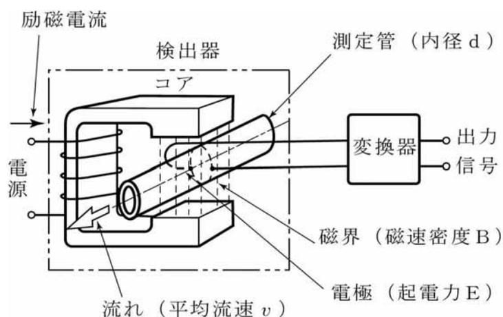
図 6-4 電磁流量計の測定原理
