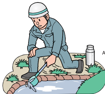
池、水路の水の採取 (水の油臭、油膜、TPH)
