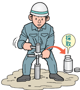
地表付近の土壤の 採取方法 (土壤の油臭、油膜、TPH)
