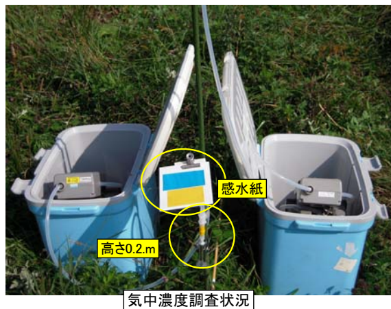
写真2 散布状況及び感水紙による気中濃度調査状況
