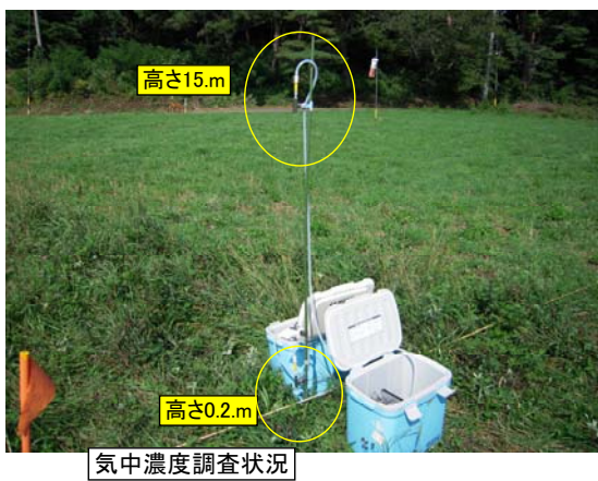
写真2 散布状況及び感水紙による気中濃度調査状況
