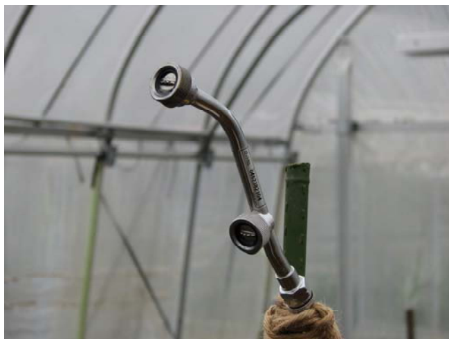
図 I -3. 慣行ノズル (ヤマホ・新広角タテ2頭口ノズル)
