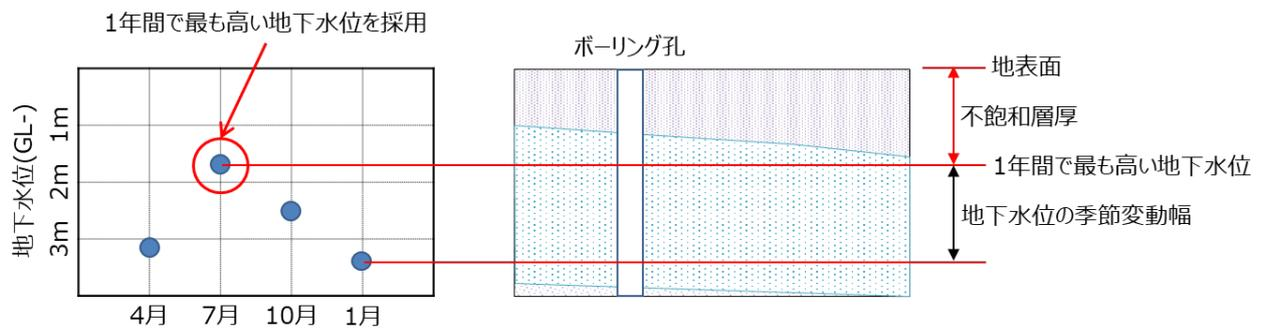
図-23 地下水水位の判断の例
