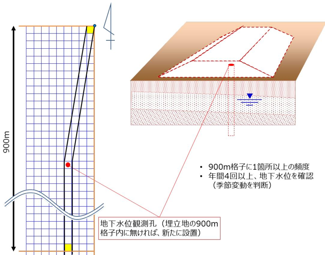
図-22 地下水水位測定ポイントの例
