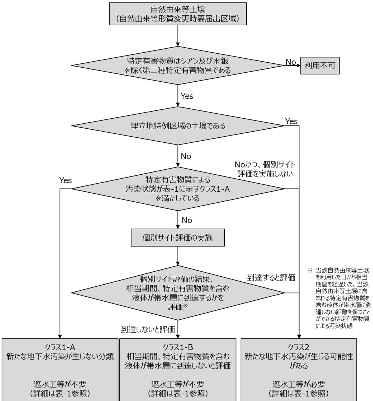
図-1 自然由来等土壌構造物利用施設における地下水汚染防止措置を決定する判断フロー
