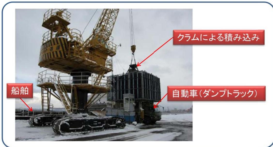
図 3.6.6-1 埠頭における積替え作業の例
