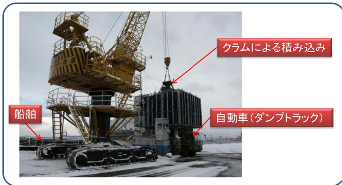
図 3.6.6-1 埠頭における積替え作業の例
