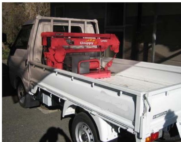
図5-16 網を持ち上げるクレーンの例
