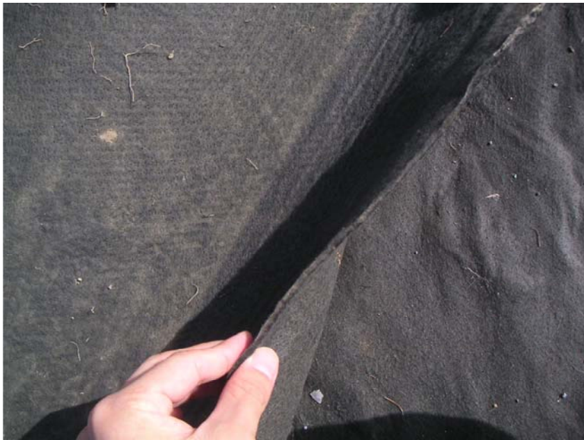
透水性シート（不織布）の状況 （厚さ 4mm）
