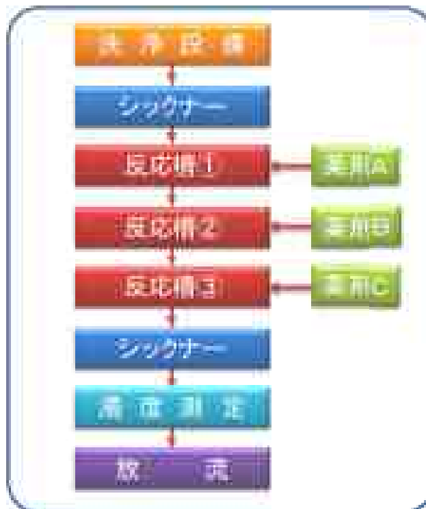
図 2.1.3-6 洗浄処理における汚水処理フロー図の例
