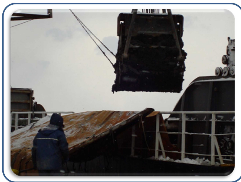
図 3.6.6-2 落下防止措置の例
