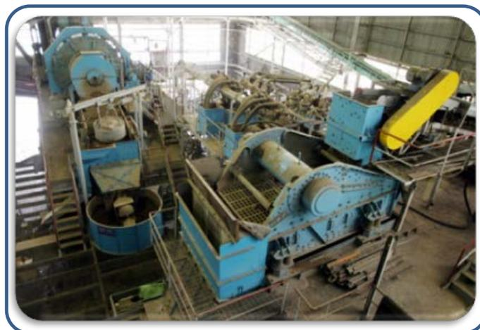
図 1.5.1-1 浄化等処理施設（浄化（抽出－洗浄処理））の例
