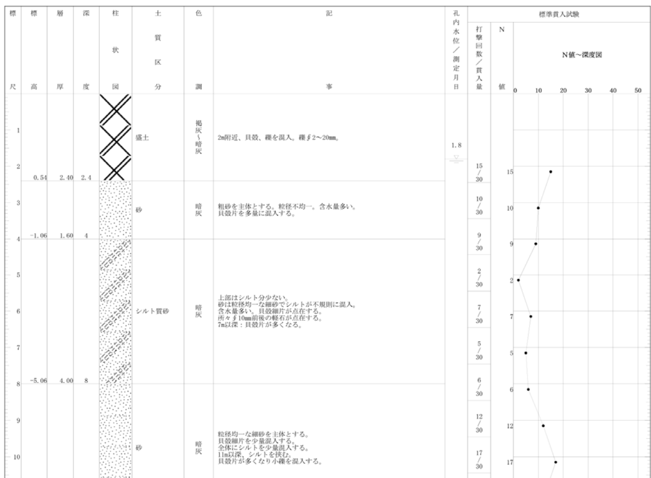
図-11 地質柱状図の一例
