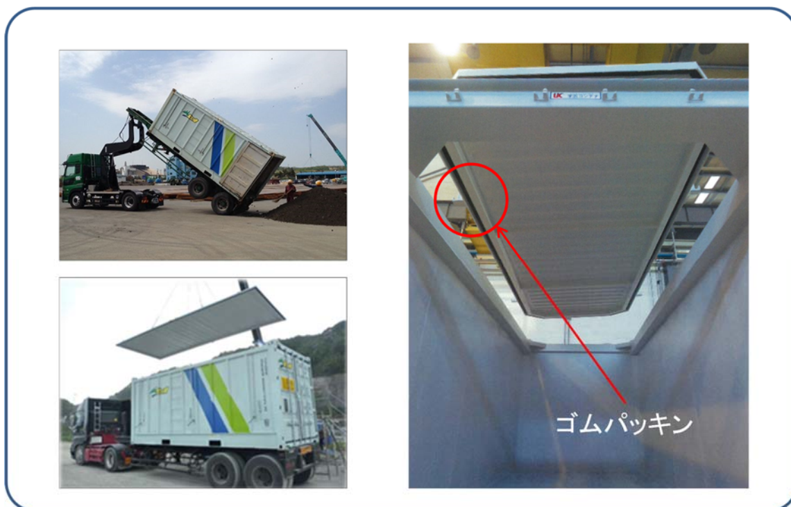
図 3.4.1-4 JIS 等密閉型コンテナの一例（IS01496-1 の密閉型のコンテナ）
