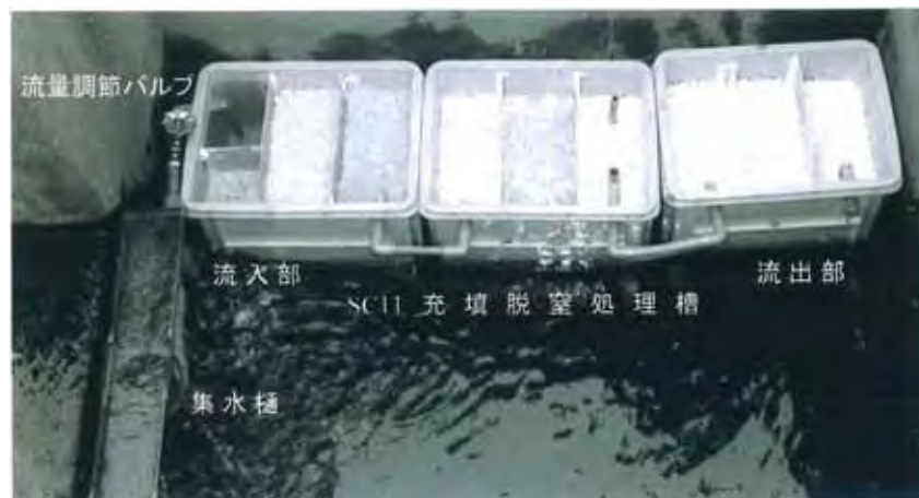
図 6-2-2 暗渠排水脱窒テストプラント（SC11 充填量 80kg、埼玉県深谷市）
