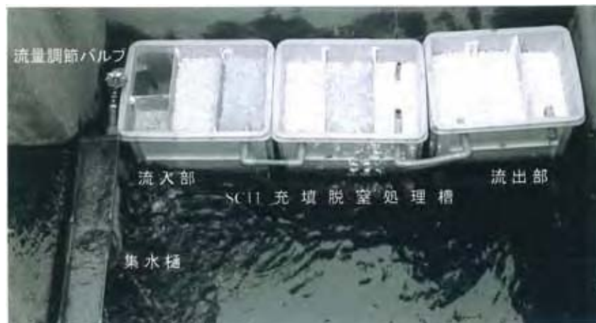
図 6-2-2 暗渠排水脱窒テストプラント（SC11 充填量 80kg、埼玉県深谷市）
