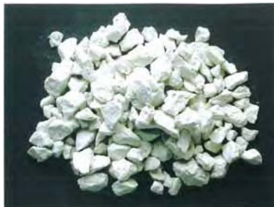
図 6-2-1 硫黄-石灰石脱窒資材 SC11 (5-20mm)
