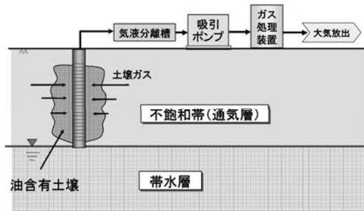
図 8-242 土壌ガス吸引の概念図
