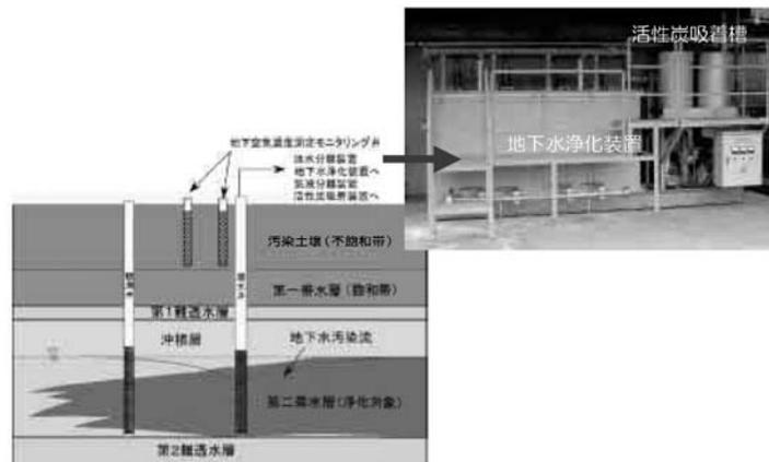
図 8-5 地下水揚水の概念図
