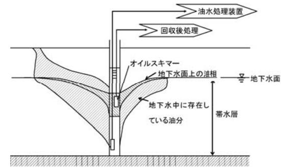
図 8-212 地下水揚水の概念図
