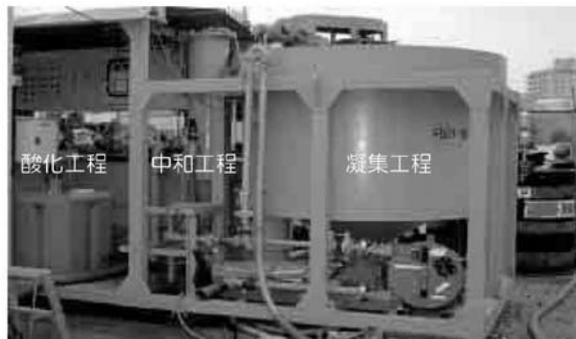
図 8-123 酸化、中和、凝集装置の概況写真
