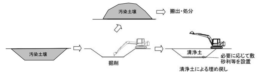
図 8-1423 (再掲載) 掘削除去の概要図
