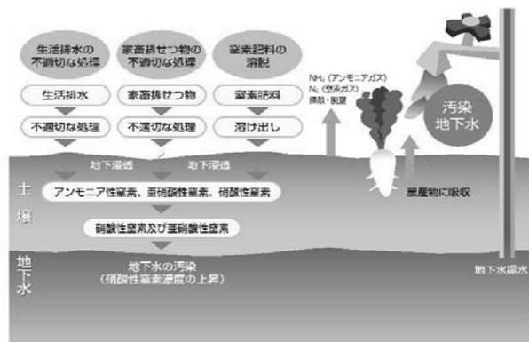
図-6 硝酸性窒素の地下水汚染のしくみ<sup>2)</sup>
