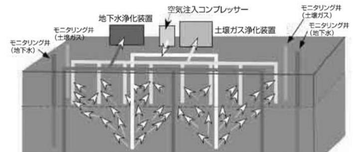
図 8-7 エアースパーキング工法の概念図
