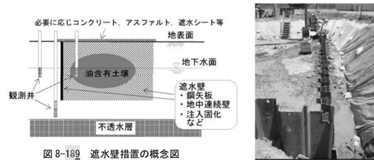
図 8-189 遮水壁措置の概念図
