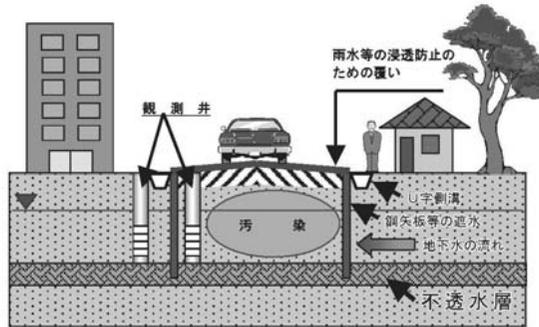
図 8-156 原位置封じ込めの概念図
