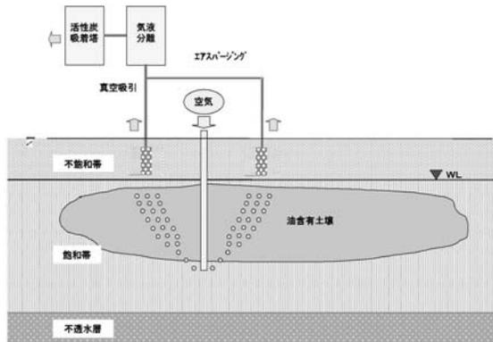
図 8-235 エアスパージングの概念図
