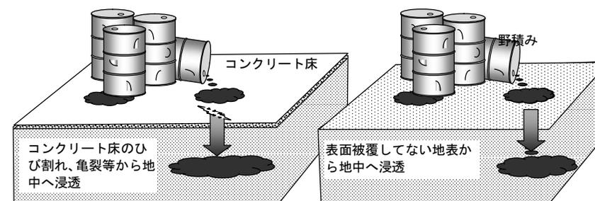
図2-65 有害物質を含む水が貯蔵場所で漏洩し、その場で地下に浸透した事例
