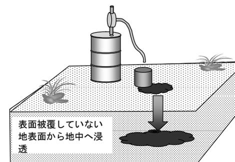
図2-76 移し替え時のこぼれ等により、有害物質を含む水が地下に浸透した事例
