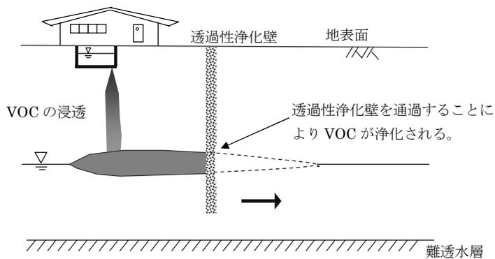
図 8-9 透過性浄化壁の概念図<sup>3)</sup>
