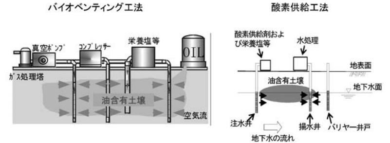
図 8-246 原位置バイオレメディエーションの概念図
