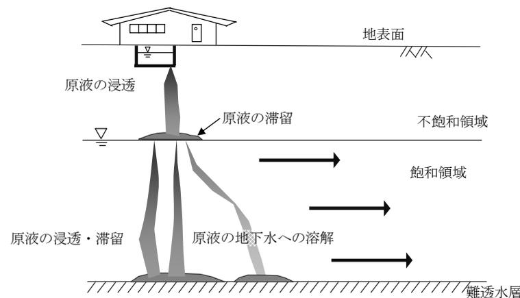
図-4 DNAPL (Dense Non-aqueous Phase Liquid) による地下水汚染の拡散状況 模式図<sup>3)</sup>
