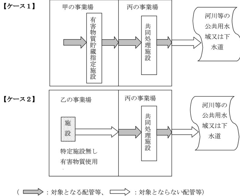
○ これらの事例のように、配管等、排水溝等が、異なる事業場間に設置されている場合、構造等に関する基準遵守及び定期点検の実施の義務の適用は、基本的には敷地の中までの配管等、排水溝等が対象となる。
