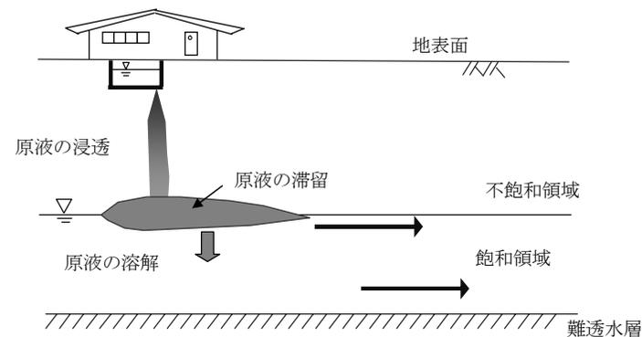
図-3 LNAPL (Light Non-aqueous Phase Liquid) による地下水汚染の拡散状況 模式図<sup>3)</sup>
