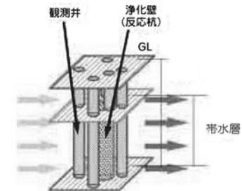
図 8-178 透過性浄化壁工法の概念図
