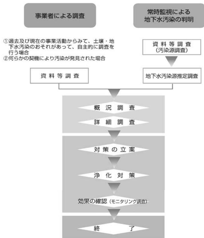
図 8-3 地下水汚染判明時の調査・対策フロー図<sup>2)</sup>
