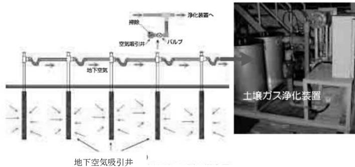
図 8-4 土壌ガス吸引の概念図
