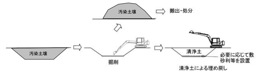
図 8-145 掘削除去の概要図
