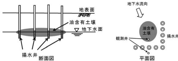
図 8-201 バリア井戸措置の概念図
