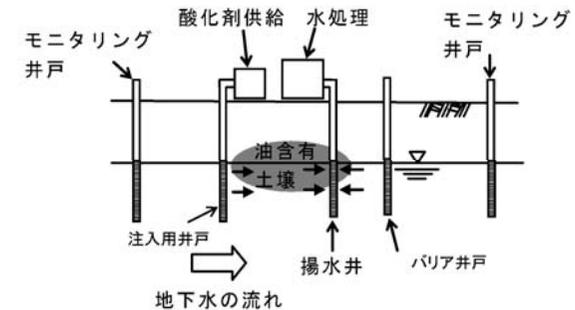
図 8-257 化学的酸化分解の概念図
