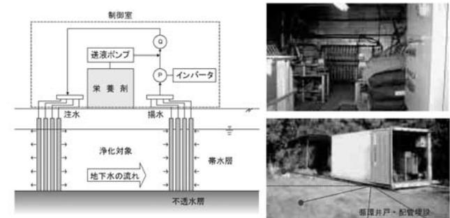
図 8-11<sup>10</sup> バイオレメディエーションの浄化概念図（左図）および浄化装置（右写）
