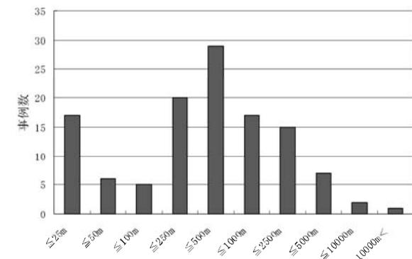
図-1 揮発性有機化合物（VOCs）の汚染の到達距離の頻度予測（汚染発生100年後）<sup>1)</sup>
