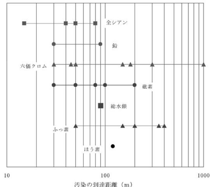
図-2 重金属等の汚染の到達距離<sup>1)</sup>
