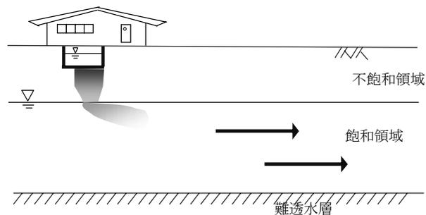
図-5 重金属等の溶液による地下水汚染の拡散状況 模式図<sup>3)</sup>
