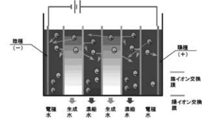
図 8-167 電気透析法の概念図
