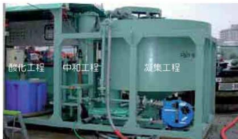
図 5-12 酸化、中和、凝集装置の概況写真
