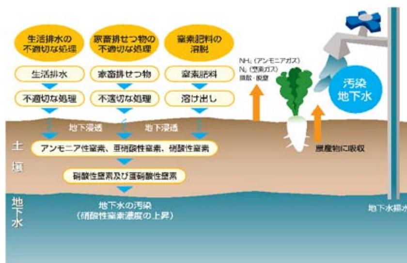
図2-6 硝酸性窒素の地下水汚染のしくみ
