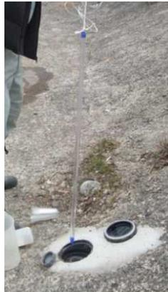
※ベラー採水器：写真のような地下水の採取用の管。検査管・観測井などに挿入することで、採水器内の球が動き地下水を採取できるようになっている。
