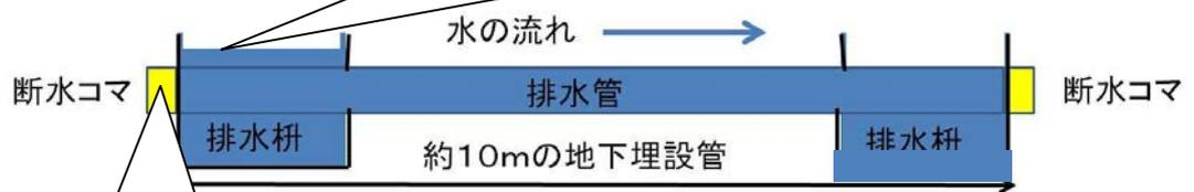
断水コマの内部にエアポンプで空気を挿入して既存配管との密着(断水)を図る。
