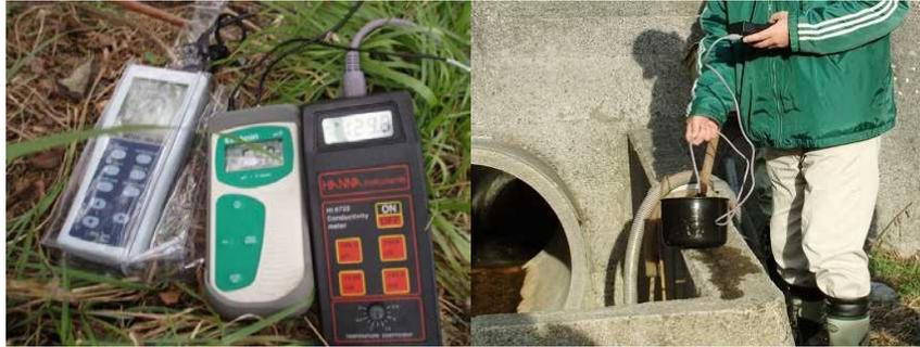
電気伝導率計（左写真の右）・pH計（左写真の中央）と計測（右写真）の例
