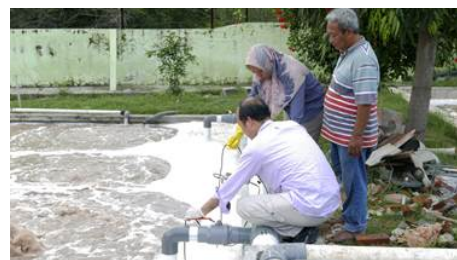
送風量調整・水質測定
