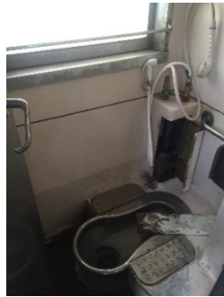
水洗トイレが設置されているが 未処理のまま垂れ流しの状態が続いている
