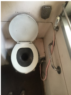
水洗トイレが設置されているが 未処理のまま垂れ流しの状態が続いている
