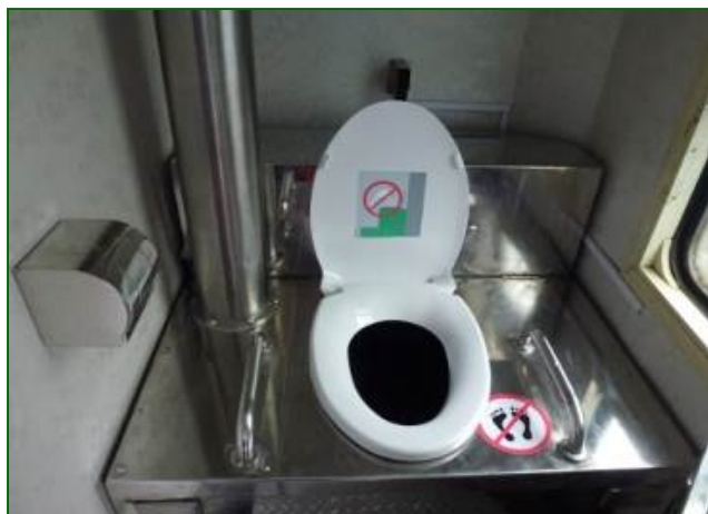
ベトナム国鉄車両へ導入するバイオトイレ
