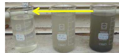
右から調整槽内水、 実証試験装置の流入水、処理水
