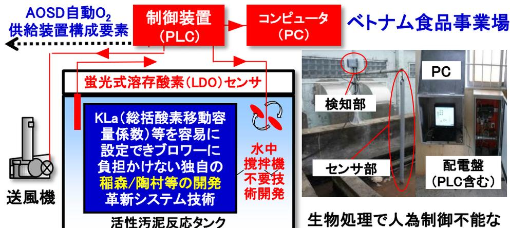
生物処理で人為制御不能な原水変動に自動追従し**処理の安定性向上と電力削減を達成。**
