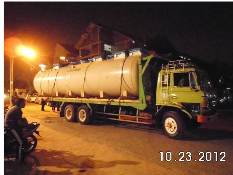
⑳浄化槽搬入
