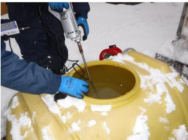
pH 調整タンクの HCL (1+5) 添加、pH 測定
