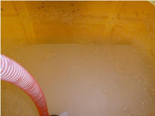
沈降タンク沈降後 上澄水を pH 調整タンクに返送
