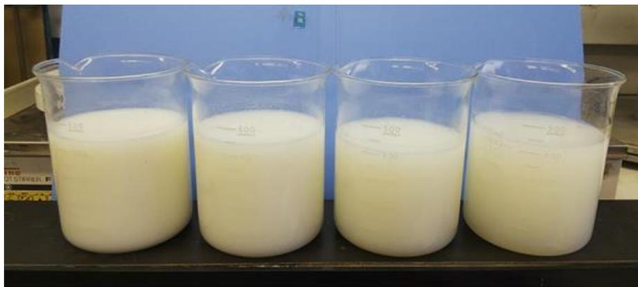
写真 6-1. COP 法による源泉中のほう素除去(攪拌後・静置)
