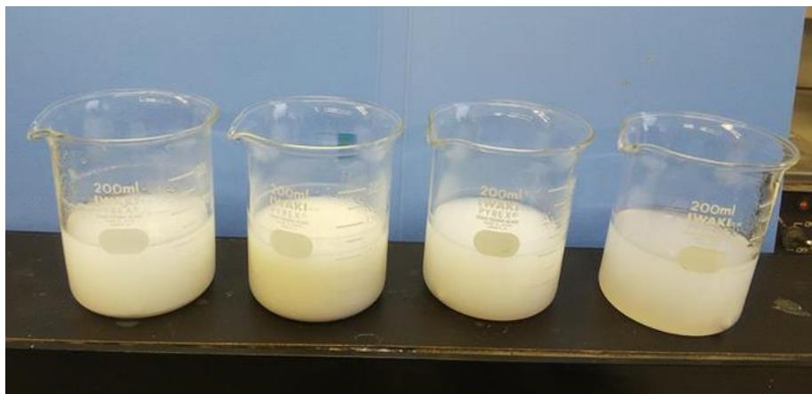
写真 6-2. HAp 法による実排水中のほう素除去(攪拌後・静置)
