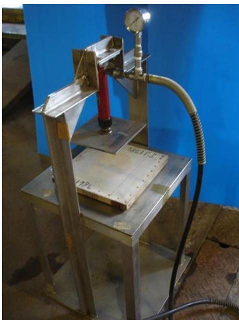
写真8-2. 油圧ジャッキ式簡易脱水試験機
