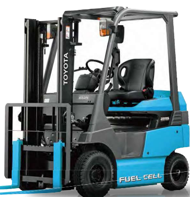
2.5t積み燃料電池フォークリフト 2.5-ton capacity fuel cell forklift
