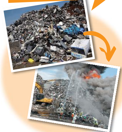
スクラップ中に廃家電が混入していると、火災につながります。
