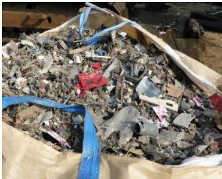
金属以外に雑多な物が混入した破砕物の例
