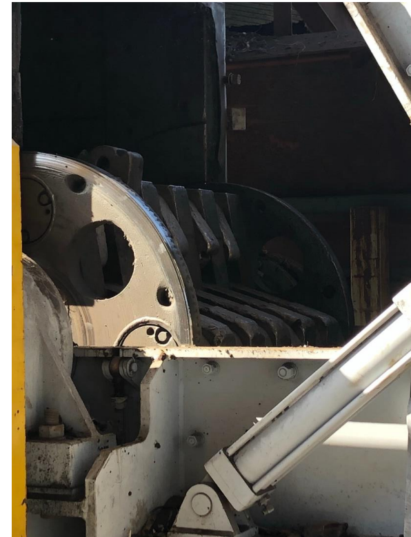
据付された横型ハンマーシュレッダー（中古の日本製破碎機）
