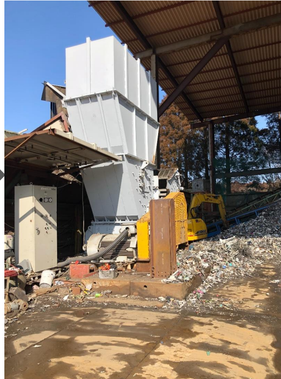
据付された横型ハンマーシュレッダー（中古の日本製破碎機）
