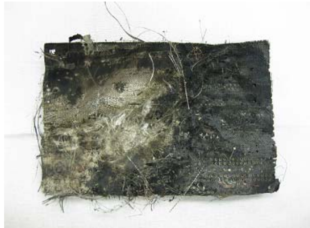
図 15 LVL とクレゾールから製造した 溶媒タールで可溶化された廃基板
