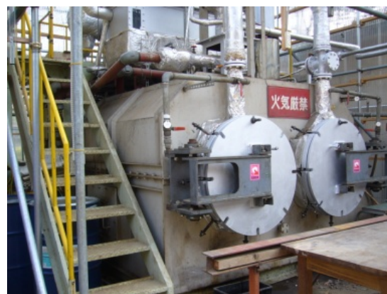
図 4 小型バッチ式密閉型外熱式乾留炉の外観
