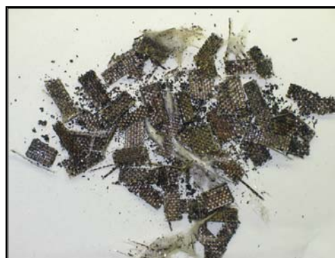
図8 乾留タール中でエポキシ基板を可溶化した際に回収されたガラス繊維（220℃）
