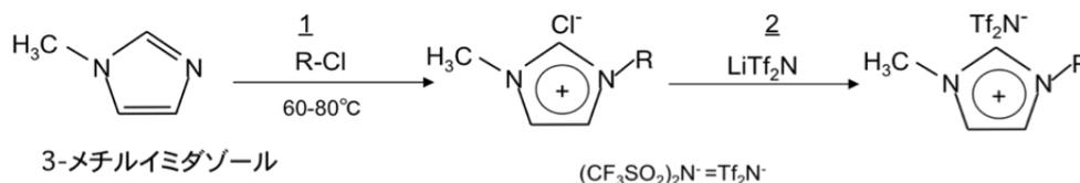
図5. イオン液体の合成スキーム
