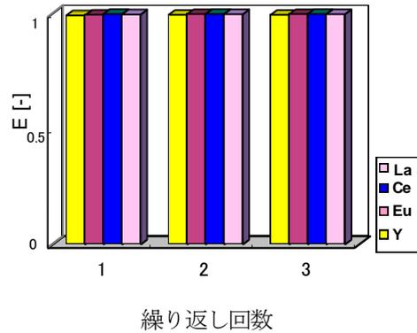
図 19. イオン液体再利用の抽出性能への影響 (DODGAA/C<sub>4</sub>mim)
