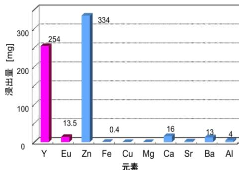
図4. 金属浸出例 浸出量/CRT 廃蛍光体 1g
