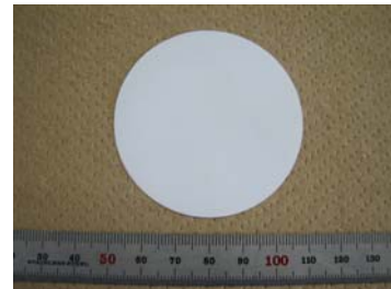
図 5 ベントナイト漏洩防止用のフィルター
