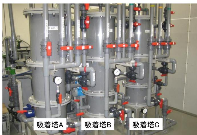
吸着塔を3系並列に設置し、順次、吸着反応、脱離反応、再活性化を行うことで切れ目無く連続運転が可能。
