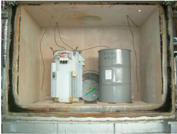
図3 変圧器及びケーブルを入れた ドラム缶の炉内設置状態
