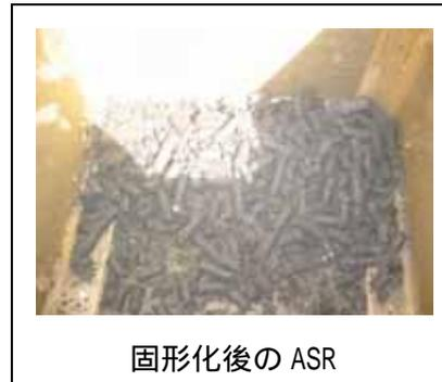
a. 結果：固形化後の形状は安定しており、軽度の衝撃では崩れることはなかった。対象物の投入前単位容積質量は、平均で  $0.12 \text{ t/m}^3$  であったが、固形化後では約  $0.45 \text{ t/m}^3$  となり、約 1/4 の減容率となった。
