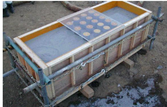
写真-4 充填性試験の様子
