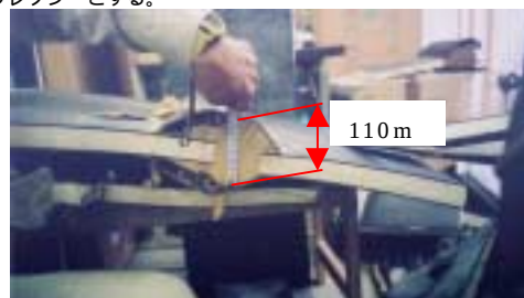
写真-5 ジョイント厚測定結果(No.8)
